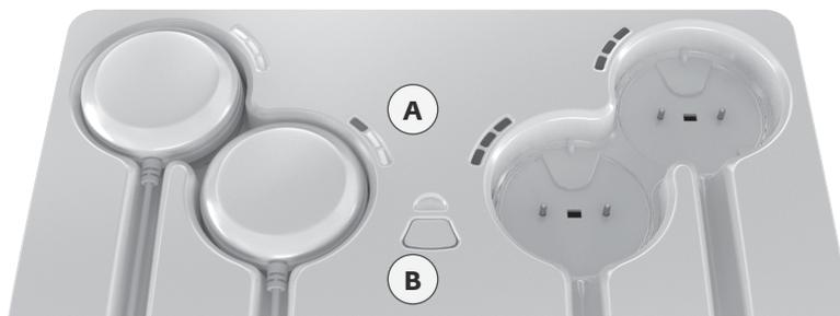
Если в зарядную станцию вставлены 2 или более пульта ДУ, вы сможете отдельно вести 2 или более сеансов процедур. Пульты ДУ и соответствующие модули, синхронизированные с ними, будут находиться под отдельным управлением до следующей синхронизации. Сеансы могут начинаться независимо друг от друга.
